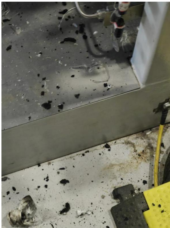
图 3 事故现场聚氨酯泡沫保温层燃烧产生的碎屑
